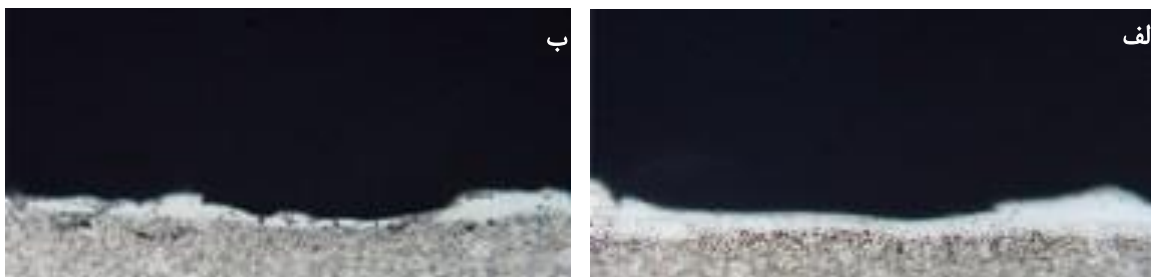
شکل ۱- لایه‌های ایجاد شده پس از عملیات ماشین‌کاری [۱۰]
