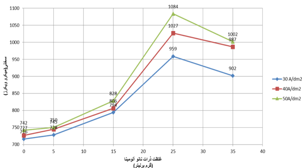
شکل ۹- نمودار تغییرات سختی در جریان ثابت ۳۰، ۴۰ و ۵۰ آمپر بر دسی متر مربع
