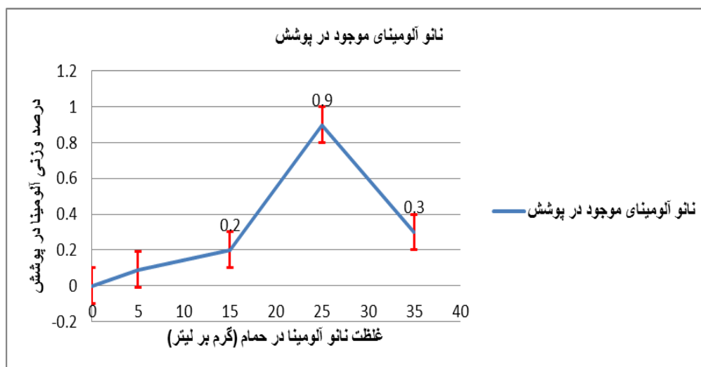
شکل ۴- رابطه غلظت نانو ذرات در حمام و درصد وزنی آن در پوشش نهایی
