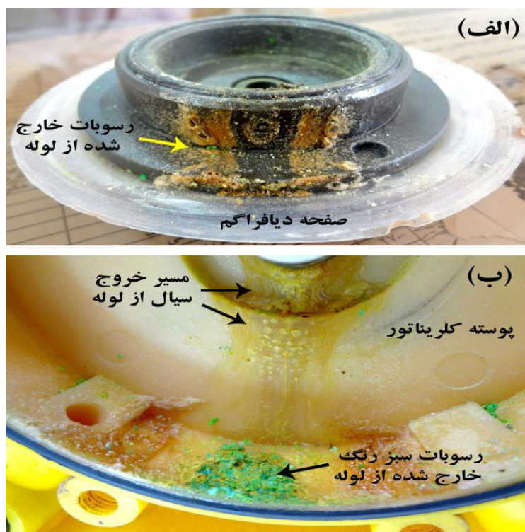
شکل ۴- صفحه دیافراگم (الف) و پوسته داخلی کلریناتور (ب) و همچنین مسیر عبور سیال و حضور رسوبات خارج شده از لوله
