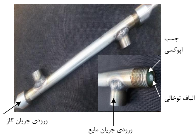
شکل ۳ - ماژول تماس دهنده غشایی گاز-مایع
