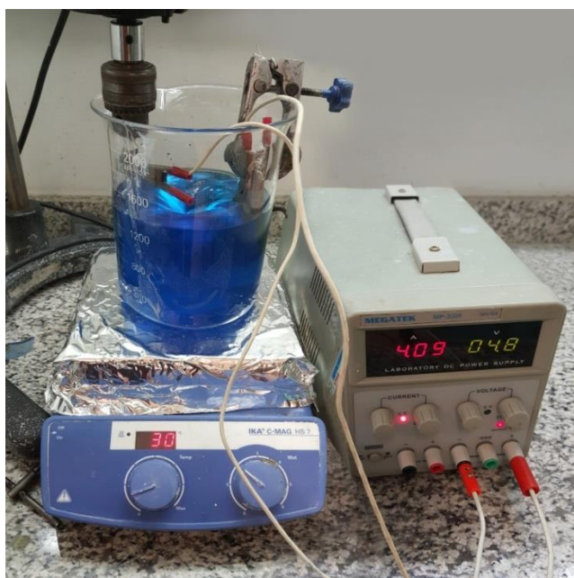
شکل ۱- نمایی کلی از حمام آبکاری و تجهیزات جانبی مورد استفاده برای فرآیند الکتروفرمینگ
