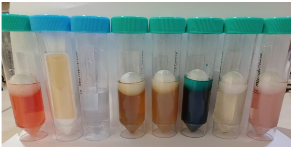
شکل ۲- کیت میکروبی شاهد شامل TBC، APB، FP، JRB، NRB، Aero، SRB و TRB
