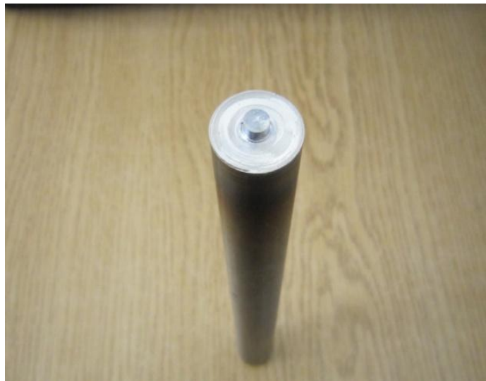
شکل ۲- ابزار مورد استفاده در فرایند FSP.
