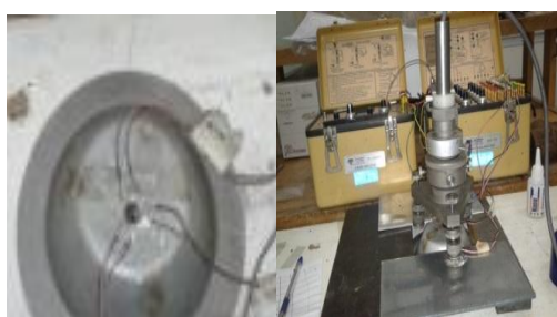
شکل ۴- آماده سازی قطعه جهت اندازه گیری تنش پسماند
