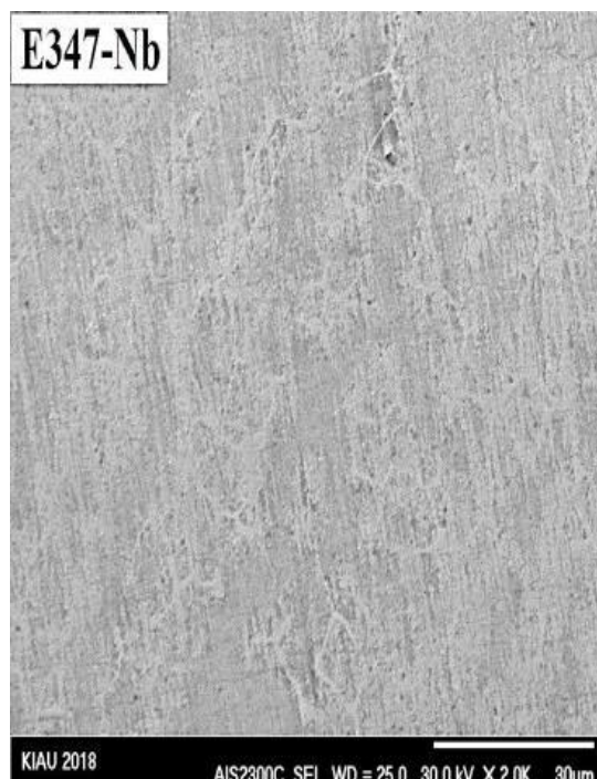
شکل ۳- تصویر SEM از فلز جوش مربوط به الکتروودهای مختلف (الف) E347-V (ب) E347-Nb
