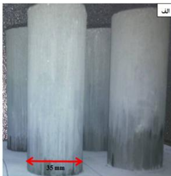
شکل ۶- نمونه (الف) ۱۰۰ گرمی و (ب) یک کیلوگرمی خام آماده شده جهت احیا
