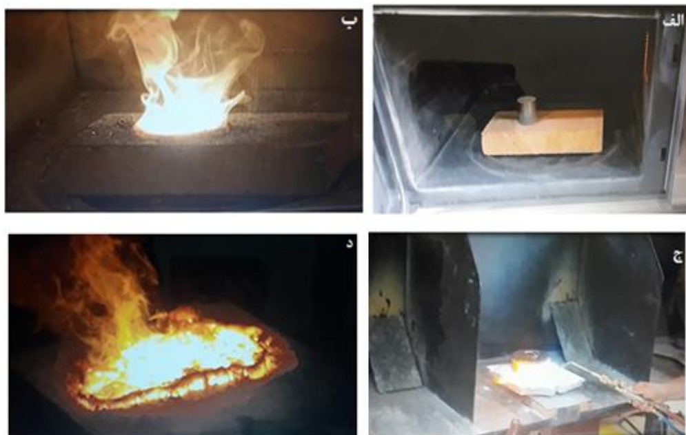
شکل ۷- (الف) نمونه ۱۰۰ گرمی قبل از احیا درون ماکروویو (ب) نمونه ۱۰۰ گرمی بعد از احیا درون ماکروویو (ج) نمونه یک کیلویی به هنگام احیا با شعله اکسی استیلن (د) نمونه یک کیلویی بعد از احیا با شعله اکسی استیلن
