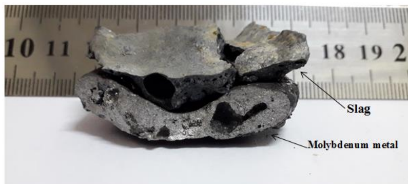
شکل ۸- تصاویر مربوط به نمونه ۱۰ گرمی احیای آلومینوترمی تری اکسید مولیبدن درون ماکروویو (الف) دکمه و (ب) پوسته تشکیل شده
