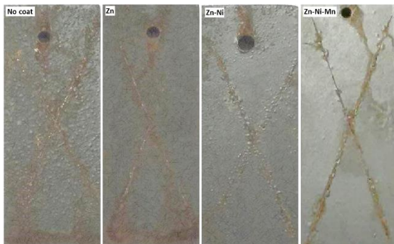
شکل ۶- تصاویر سطح نمونه‌های فسفات‌ه‌ و رنگ شده پس از ۲۴۰ ساعت آزمایش پاشش نمک
