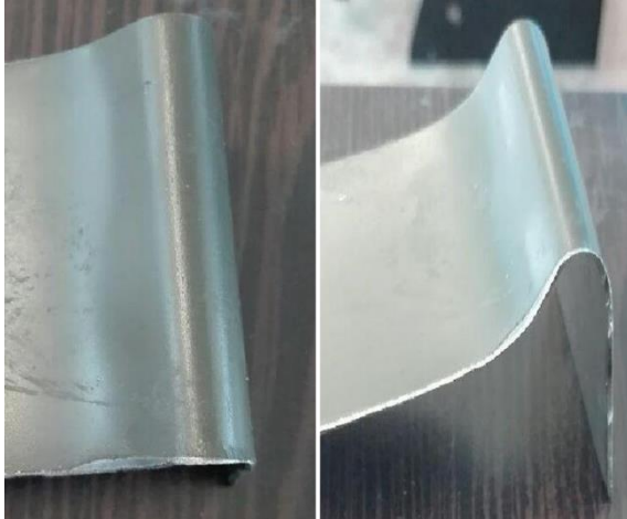
شکل ۹- نتیجه آزمایش خمش پوشش فسفات‌ه سه کاتیونی
